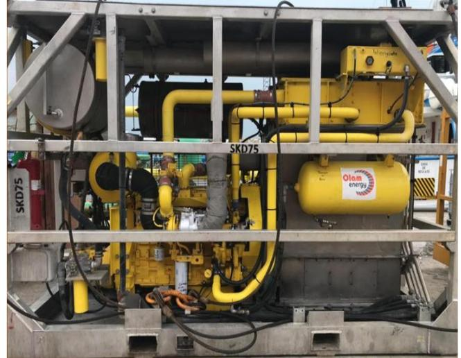
Se utiliza un tanque de almacenamiento externo de LN2 que proporciona LN2 a la bomba de refuerzo a aproximadamente 10-45 PSI de presión de LN2. El nitrógeno líquido de baja presión se aplica a la bomba tríplex (de alta presión presurizada) hasta 10,000 PSI, y se gasifica en un vaporizador ambiental de aire forzado que utiliza energía térmica del escape del motor de Diesel y el aire ambiental de alta velocidad para convertir el líquido en gas.
